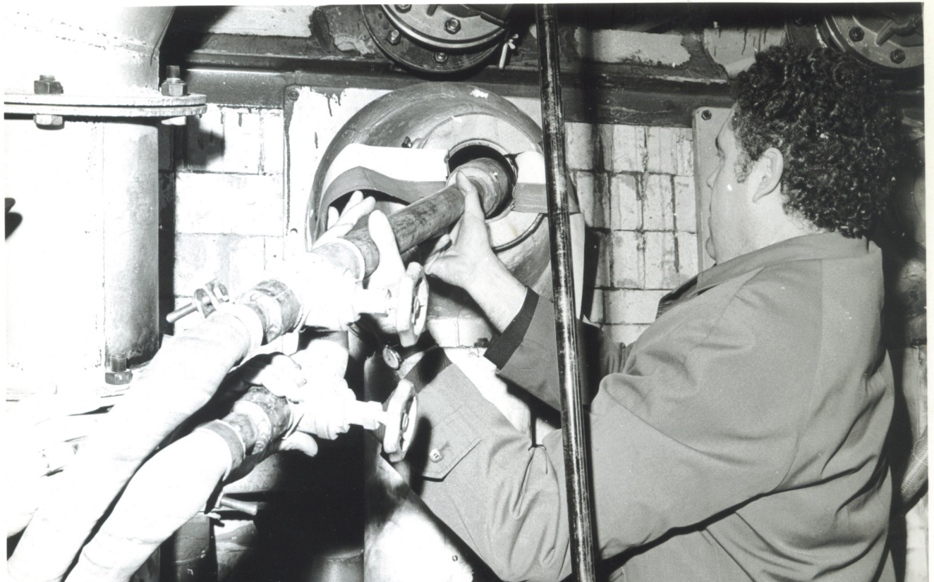
Rok 1974. Rozpalenie pieca wannowego do topienia szkła przeznaczanego do automatycznej produkcji kieliszków (pierwszej w kraju) dostarczonego przez firmę Sorg z RFN.
